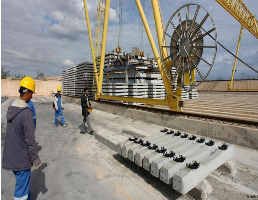
صورة رقم ( 14 ) توضح تصنيع العوارض الخرسانية
